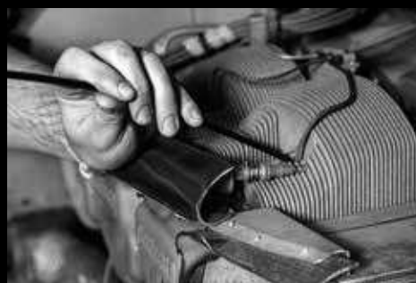
Ispezione di un cilindro in un motore aeronautico con VSA2-1M
